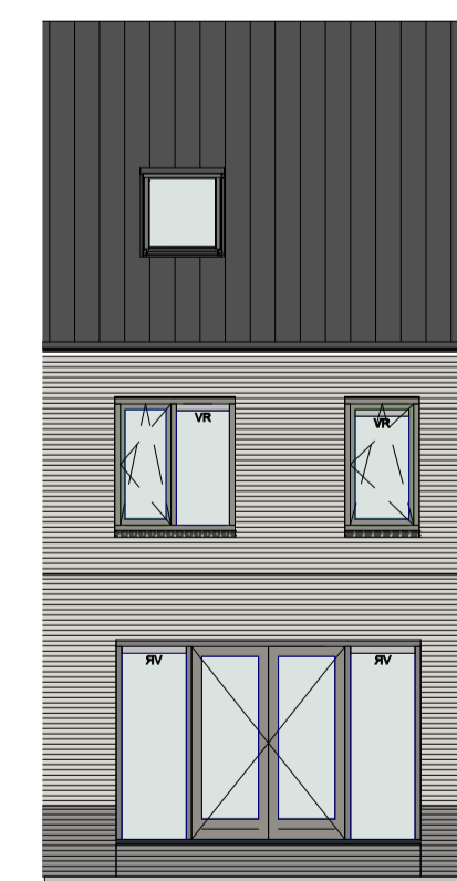
achtergevel - 1200 uitbouw + dubbele deur
