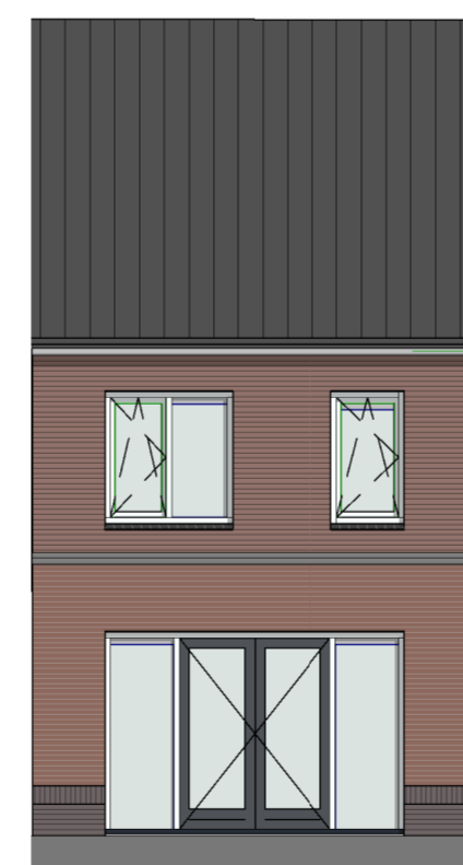
achtergevel - 1200 uitbouw + dubbele deur 1:100
