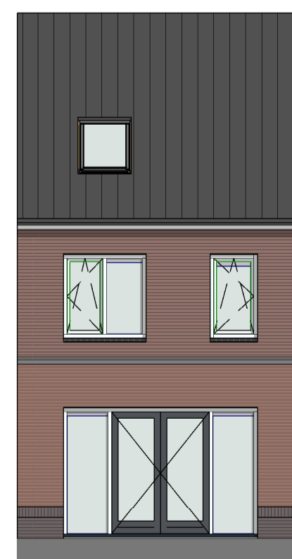
achtergevel - 1200 uitbouw + dubbele deur
