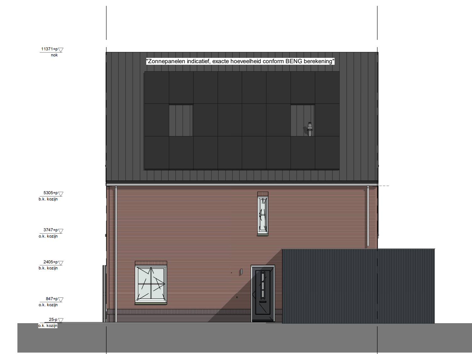
bouwnummer get. 18 Type Q2 rechter zijgevel 1:100
