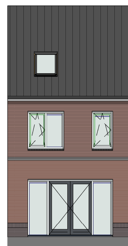
achtergevel - 1200 uitbouw + dubbele deur 1:100
