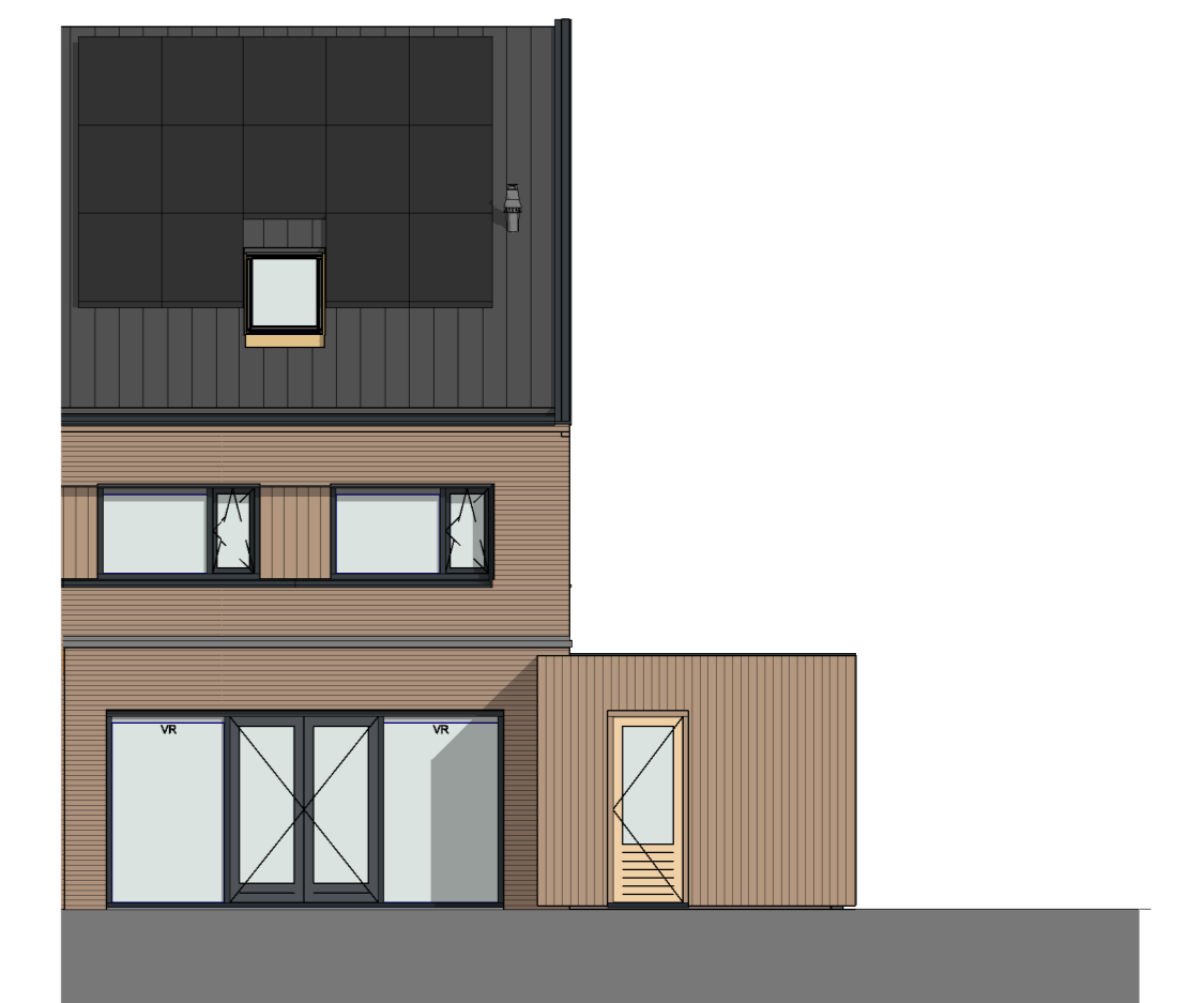
achtergevel - 1200 uitbouw + dubbele deur 1:100
