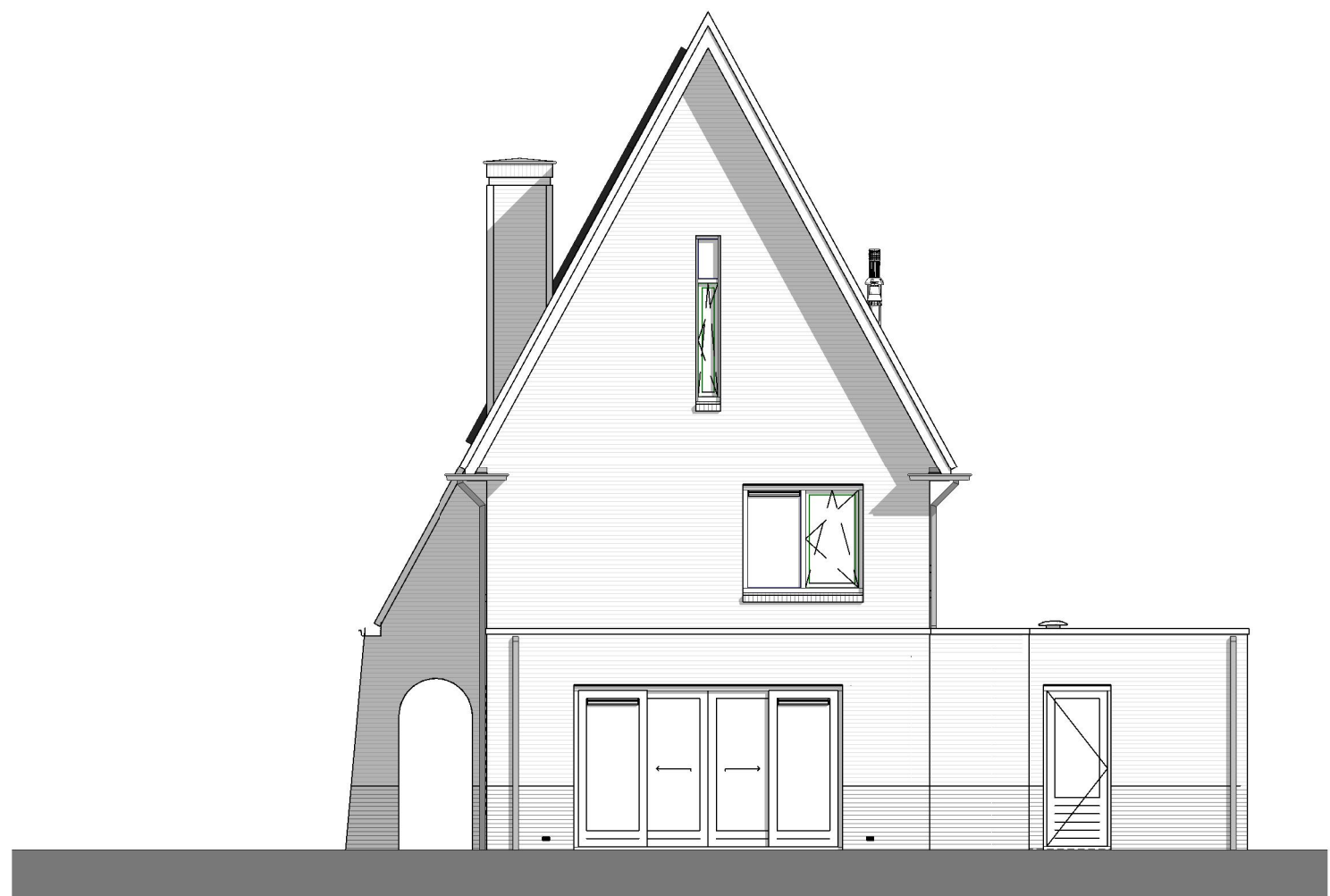
bouwnummer(s) get. 271 en 281 achtergevel - uitbouw 1200 / 2400 + schuifpui
